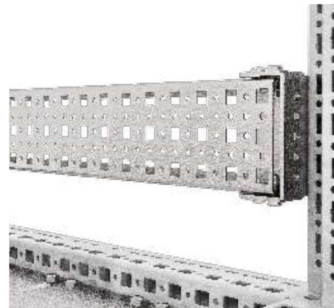
Планка монтажная 23x73 предназначена для монтажа навесного оборудования при помощи резьбовых винтов с шагом 12,5 мм, клетевых гаек и винтов с шагом 25,0 мм. Крепится при помощи специальных комплектов крепления планок. Дополнительно необходимо приобрести комплект крепления планок RS52 23x73.
