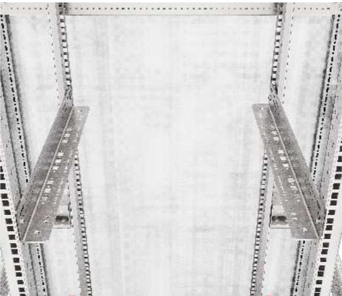
Монтажные шины 42х57 предназначены для монтажа 19-дюймового оборудования между передней и задней монтажными плоскостями в качестве опоры для тяжелого оборудования. Боковая системная перфорации обеспечивает боковую вентиляцию компонентов. Эффективная опорная поверхность - 51 мм.
