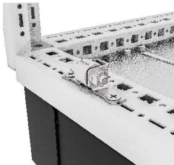
Ролик опорный двери RS52 предназначен для поддержки двери при наличии установленных тяжелых компонентов, таких как система вентиляции и кондиционирования. Служит для облегчения процесса запираения двери. Ролик крепится на раму основания, уголок упора крепится к нижней части профиля двери.
