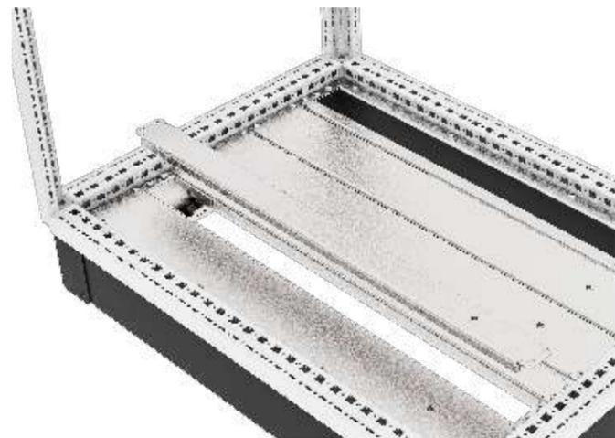
Панель основания глухая средняя 50 мм RS52 предназначена для закрытия основания шкафа, используется в комбинации с другими панелями соответствующей ширины. Для повышения устойчивости проём основания при ширине 1000 мм и 1200 мм разделен на 2 части, который комплектуется совместно. Две панели основания шириной 50 мм заменяют одну стандартную панель 100 мм RS52. Устанавливается в центр рамы основания. Предусмотрена боковая и фронтальная установка.
