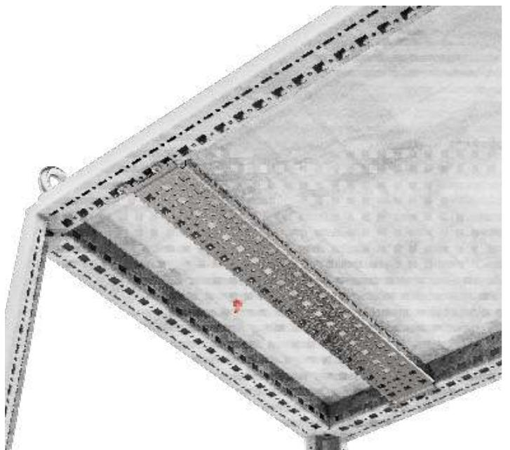
Планка монтажная с зацепами 20х73 тип К RS52 предназначена для монтажа навесного оборудования при помощи резьбовыдавливающих винтов с шагом 12,5 мм., клетьевых гаек с шагом 25,0 мм. Планка навешивается на профиль крыши и основания рамы RS52.
