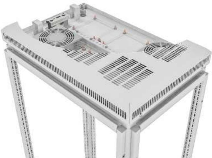
Панель вентиляторная RS52 предназначена для активной вентиляции. Устанавливается на месте стандартной потолочной панели линейных шкафов RS52 600x400 мм. Панель оснащена двумя вентиляторами серии FK6628.230.
