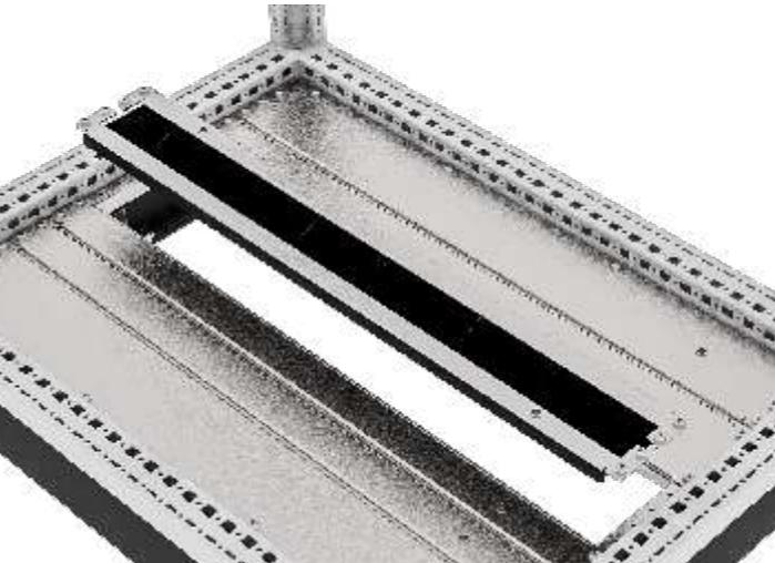
Панель уплотнения ПСУЛ средняя 100 мм RS52 двухсекционная предназначена для возможности монтажа кабелей групповых линий при помощи предварительно сжатой уплотнительной ленты ПСУЛ. Для повышения устойчивости проём основания при ширине 1000 мм и 1200 мм разделен на 2 части, который компонуется совместно. Устанавливается в центре рамы. Предусмотрена боковая и фронтальная установка.
