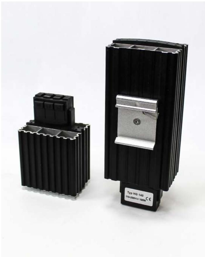
Обогреватели серии HG изготовлены из экструдированного анодированного алюминиевого профиля. Нагревательный элемент представляет собой сопротивление PTC типа, обладает функцией автоматической регулировки температуры. Монтаж осуществляется на стандартную DIN -рейку.
