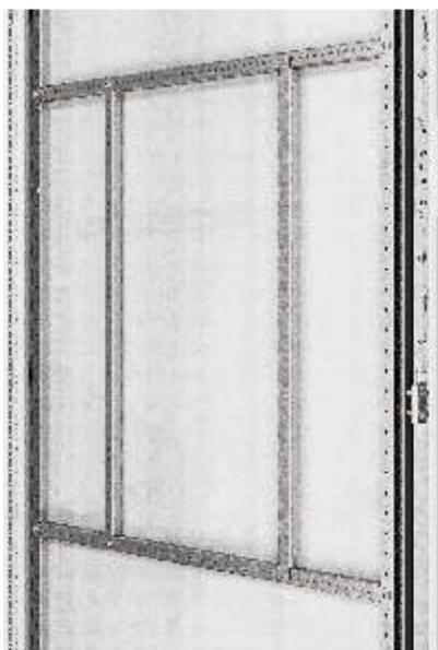
Рейка глухой двери предназначена для монтажа оборудования на внешние глухие двери шкафов RS52 в качестве горизонтальных или вертикальных направляющих для обеспечения крепления к ним проводов и иного шкафного оборудования. Статическая нагрузочная способность одной рейки до 50 кг.
