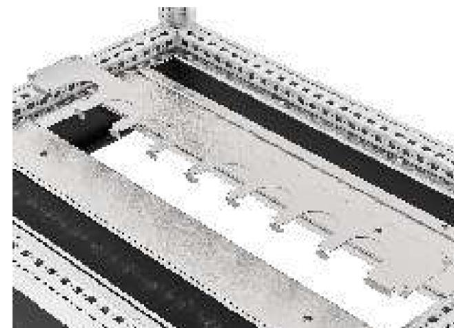
Панель кабельного ввода средняя 100 мм RS52 предназначена для организации кабельного ввода при помощи пластиковых гермовводов, путем замены панелей из базовой комплектации шкафа. Для повышения устойчивости проём основания при ширине 1000 мм и 1200 мм разделен на 2 части, который комплектуется совместно. Дополнительно необходимо приобрести кабельные вводы. Устанавливается в центре рамы. Предусмотрена боковая и фронтальная установка.
