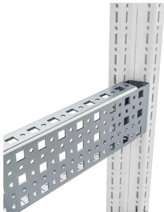
Планка ВМ монтажная тип К 23x73 предназначена для монтажа навесного оборудования при помощи резьбовых винтов с шагом 12,5 мм, клетьевых гаек и винтов с шагом 25,0 мм. Планка навешивается на наружный монтажный уровень рамы RS52, крепится при помощи специальных комплектов крепления планок. Монтаж оборудования осуществляется на внутреннем монтажном уровне.
