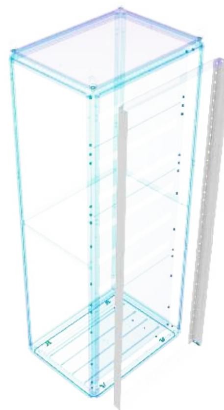
Вертикальные стойки предназначены для крепления фальш-панелей RS52. Конструкция стоек предусматривает защиту от прикосновения по высоте. Дополнительно необходимо приобрести комплект защиты от прикосновения с верхней и нижней стороны рамы.
