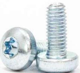
Резьбовыдавливающие винты M5x12 DIN 7500C TX самостоятельно выдавливают резьбу непосредственно в момент своего монтажа. Процесс происходит за счет специальной входной части стержня, при этом металлические стружки не остаются. Винты имеют полукруглую цилиндрическую головку и шлиц ТОРХ."
