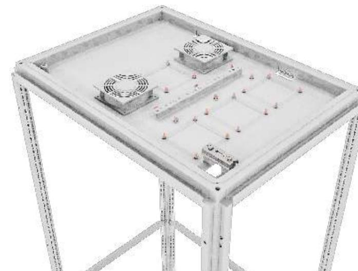
Панель вентиляторная RS52 предназначена для активной вентиляции. Устанавливается в проем потолочной панели линейных шкафов RS52 800x800 мм и 600x800 мм. Потолочная панель устанавливается на проставки M12/25 или M12/50. Панели оснащены вентиляторами серии FK6628.230. В качестве дополнительной опции блок можно расширить дополнительными вентиляторами.
