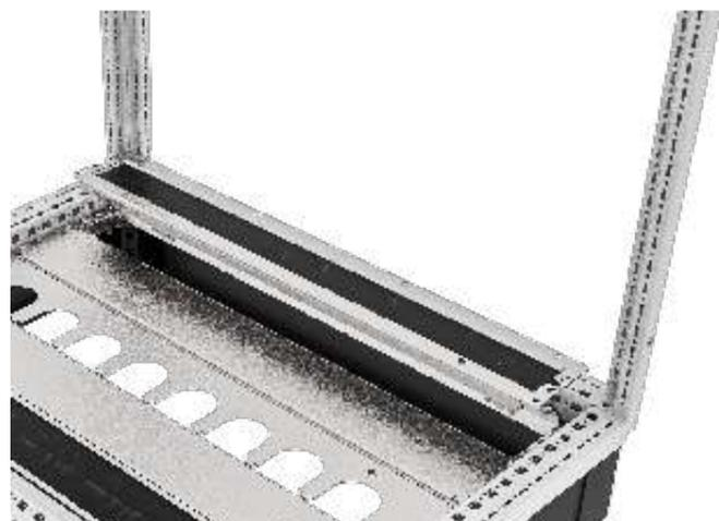
Панель уплотнения ПСУЛ RS52 концевая 100 мм двухсекционная предназначена для возможности монтажа кабелей групповых линий при помощи предварительно сжатой уплотнительной ленты ПСУЛ. Для повышения устойчивости проём основания при ширине 1000 мм и 1200 мм разделен на 2 части, который комплектуется совместно. Заменяет стандартную панель 100 мм RS52. Предусмотрена боковая и фронтальная установка.
