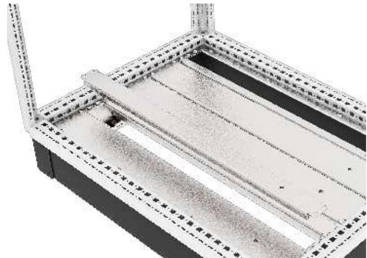
Панель основания глухая средняя 50 мм RS52 предназначена для закрытия основания шкафа, используется в комбинации с другими панелями соответствующей ширины. Для повышения устойчивости проём основания при ширине 1000 мм и 1200 мм разделен на 2 части, который компонуется совместно. Две панели основания шириной 50 мм заменяют одну стандартную панель 100 мм RS52. Устанавливается в центр рамы основания. Предусмотрена боковая и фронтальная установка.
