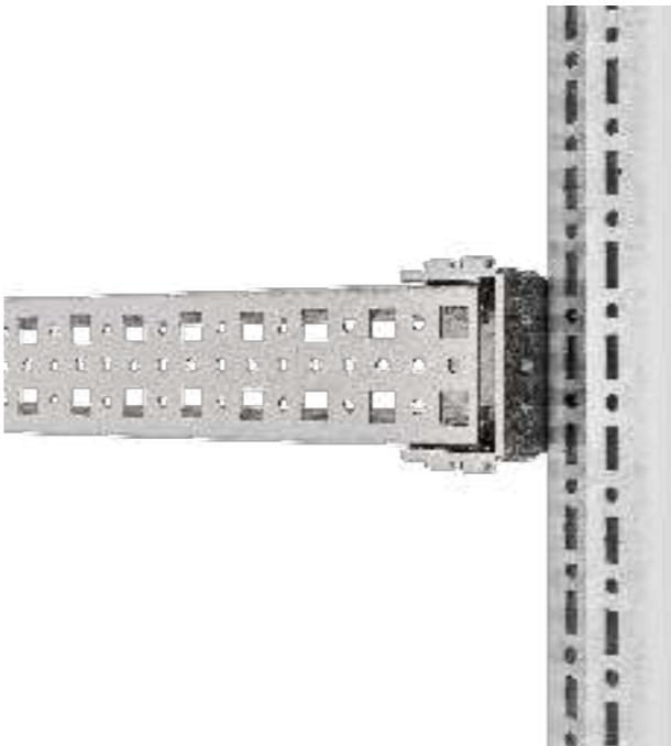
Планка монтажная 23х48 предназначена для монтажа навесного оборудования при помощи резьбовыдавливающих винтов с шагом 12,5 мм, крепежных гаек и винтов с шагом 25,0 мм. Крепится при помощи специальных комплектов крепления планок. Дополнительно необходимо приобрести комплект крепления планок RS52 23x48.
