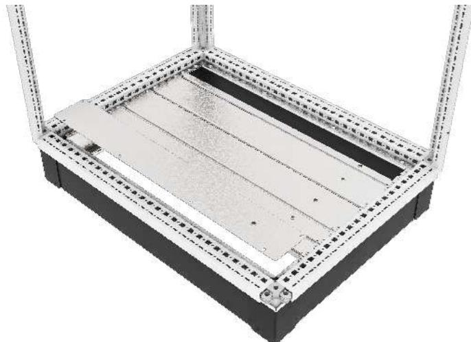
Панель основания глухая концевая 100 мм RS52 предназначена для закрытия основания шкафа, используется в комбинации с другими панелями соответствующей ширины. Для повышения устойчивости проём основания при ширине 1000 мм и 1200 мм разделен на 2 части, который компонуется совместно. Предусмотрена боковая и фронтальная установка.
