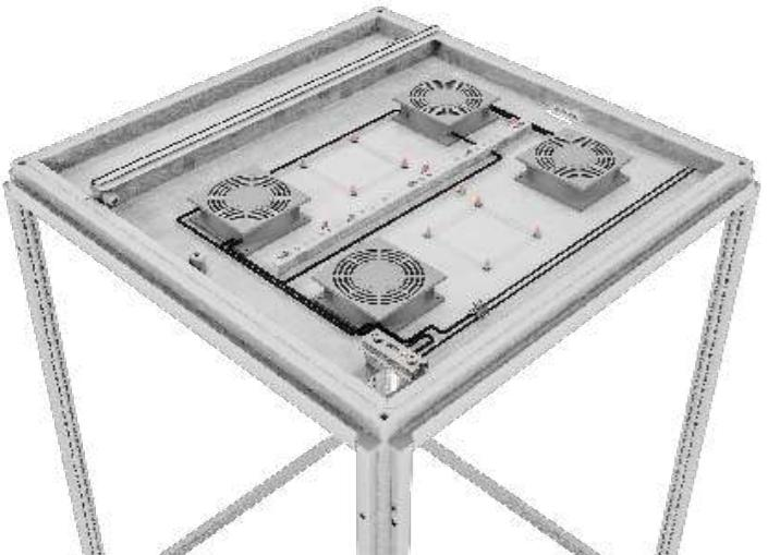
Панель вентиляторная RS52 предназначена для активной вентиляции. Устанавливается в проем потолочной панели линейных шкафов RS52 600x600 мм., 800x800 мм., 600x800 мм. Потолочная панель устанавливается на приставки M12/50. Панели оснащены вентиляторами серии FK6628.230 добором для организации места ввода кабеля. В качестве дополнительной опции блок можно расширить дополнительными вентиляторами.
