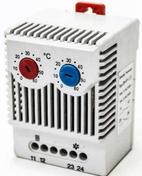
Терморегулятор совмещает в одном корпусе контакт нормально закрытый - для управления обогревателями, и контакт нормально открытый - для управления вентиляторами фильтрующими, оборудованием охлаждения и сигнальными устройствами. Степень защиты IP 20, номинальное напряжение 120, 230(AC), 24-72 (DC), частота тока 50/60.
