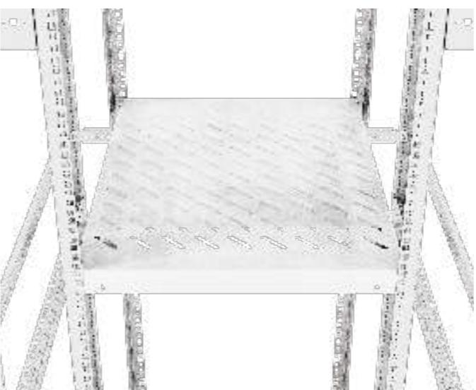
Полка для 19-дюймового оборудования с боковым креплением и регулировкой по глубине предназначена для монтажа на L-образные 19-дюймовые стойки шкафов RS52 на расстоянии от 600 до 900 мм между 19-дюймовыми стойками. Применяется на шкафах RS52 глубиной от 800 мм.
