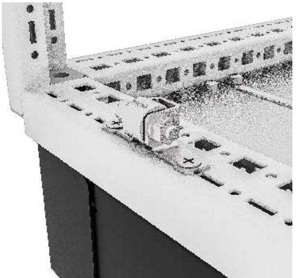
Ролик опорный двери RS52 предназначен для поддержки двери при наличии установленных тяжелых компонентов, таких как система вентиляции и кондиционирования. Служит для облегчения процесса запирания двери. Ролик крепится на раму основания, уголок упора крепится к нижней части профиля двери.
