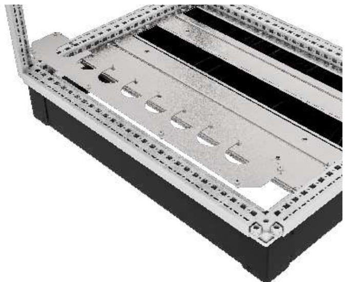
Панель кабельного ввода концевая 100 мм RS52 предназначена для организации кабельного ввода при помощи пластиковых гермовводов, позволяет выполнить позиционирование, соответствующее монтажу. Для повышения устойчивости проём основания при ширине 1000 мм и 1200 мм разделен на 2 части, который компонуется совместно. Устанавливается вместо стандартной панели 100 мм RS52. Дополнительно необходимо приобрести кабельные вводы. Предусмотрена боковая и фронтальная установка.
