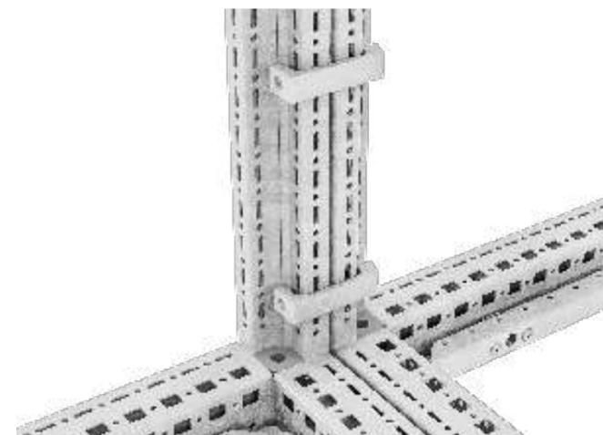
Комплект вертикальных соединителей применяется для соединения двух и более линейных шкафов RS52 на месте монтажа. Соединители устанавливаются на вертикальных стойках линейных шкафов RS52 методом стягивания двух стоек.
