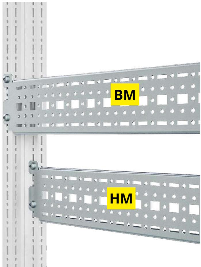
Предназначена для монтажа навесного оборудования при помощи резьбовыдавливающих винтов с шагом 12,5 мм, клетьевых гаек и винтов с шагом 25,0 мм.
