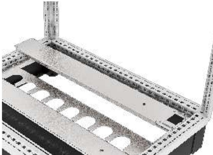
Панель основания глухая средняя 100 мм RS52 предназначена для закрытия основания шкафа, используется в комбинации с другими панелями соответствующей ширины. Для повышения устойчивости проём основания при ширине 1000 мм и 1200 мм разделен на 2 части, который компонуется совместно. Устанавливается в центр рамы основания. Предусмотрена боковая и фронтальная установка.
