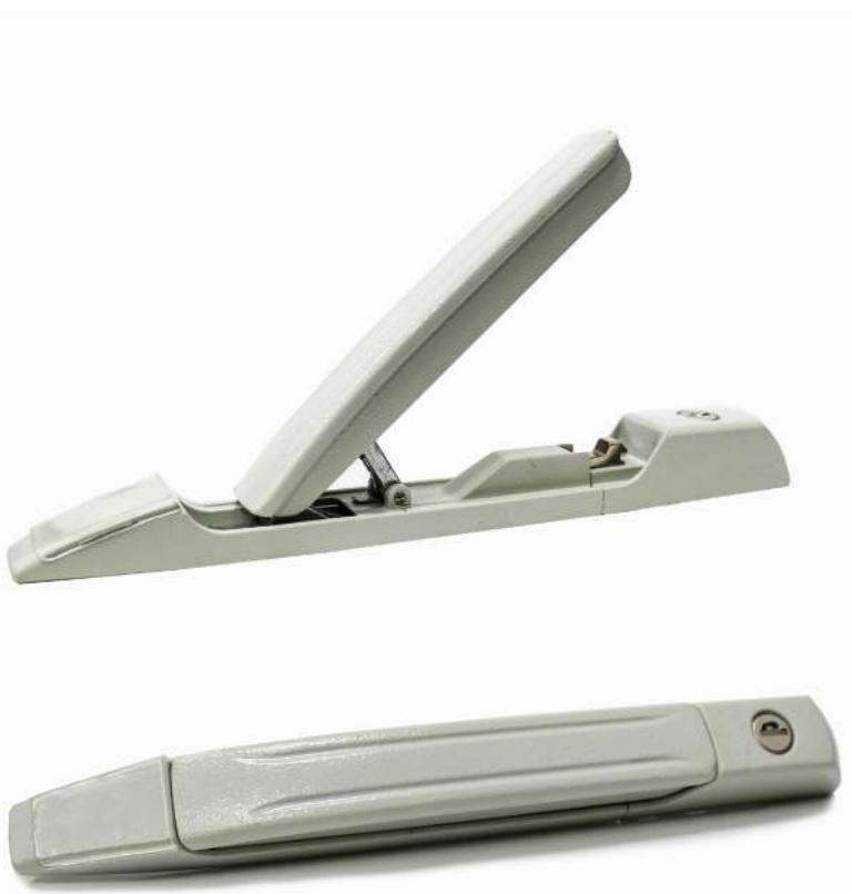
Замок-ручка комфортная применяется как альтернатива замку-накладке для более удобного открывания и запирания дверей шкафов RS52. Устанавливается в стандартные монтажные отверстия, с использованием существующих запирающих тяг. В комплекте поставляется ключ для блокировки механизма.\*
