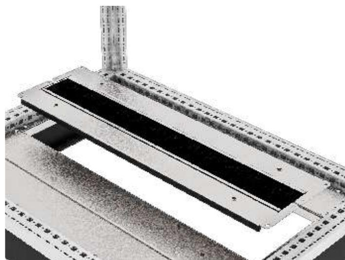
Панель с щеточным вводом средняя двухсекционная RS52 предназначена для монтажа групповых линий. Модуль с щеточным вводом шириной 200 мм заменяет комбинацию из двух стандартных панелей 100 мм RS52. Предусмотрена боковая и фронтальная установка.
