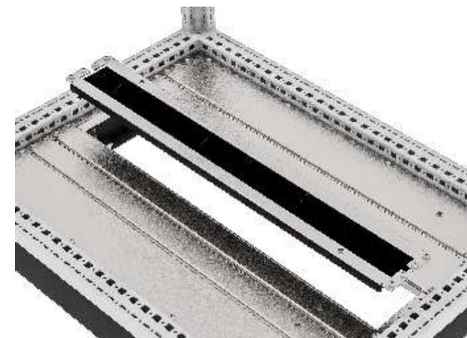
Панель уплотнения ПСУЛ средняя 100 мм RS52 двухсекционная предназначена для возможности монтажа кабелей групповых линий при помощи предварительно сжатой уплотнительной ленты ПСУЛ. Для повышения устойчивости проём основания при ширине 1000 мм и 1200 мм разделен на 2 части, который комплектуется совместно. Устанавливается в центре рамы. Предусмотрена боковая и фронтальная установка.
