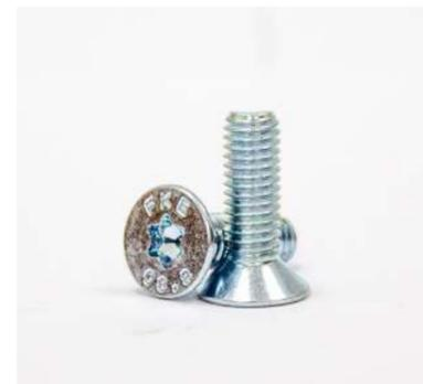
Винт M5x16 DIN 7500M TX резьбовыдавливающий с потайной головкой DIN 7500 M применяется при монтаже промежуточных боковых стенок линейных шкафов RS52. Такая конструкция позволяет винту самостоятельно создавать резьбу в металлических отверстиях.
