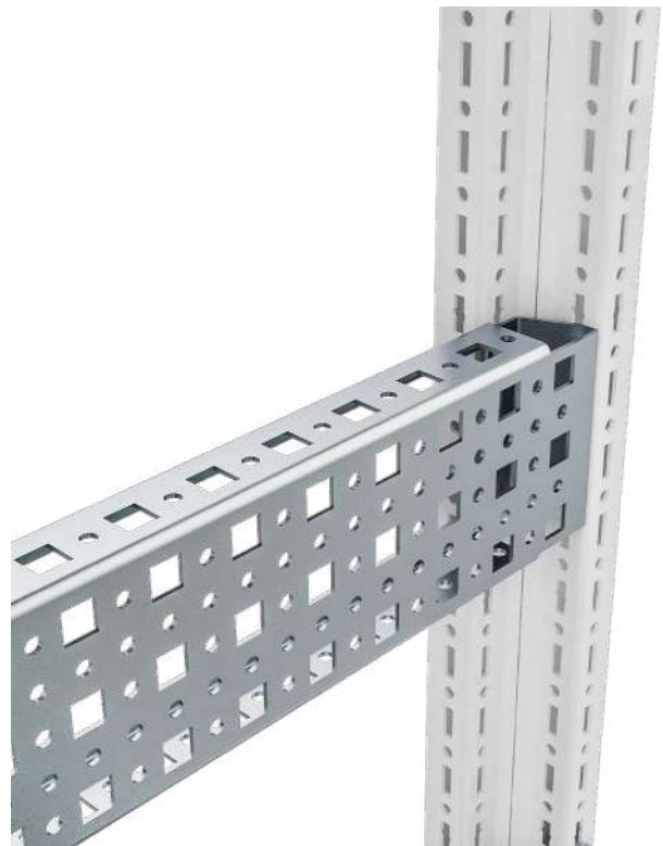
Планка ВМ монтажная тип К 23х73 предназначена для монтажа навесного оборудования при помощи резьбовыдавливающих винтов с шагом 12,5 мм, клетевых гаек и винтов с шагом 25,0 мм. Планка навешивается на наружный монтажный уровень рамы RS52, крепится при помощи специальных комплектов крепления планок. Монтаж оборудования осуществляется на внутреннем монтажном уровне.
