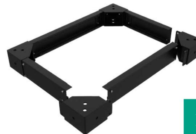
Цоколь сейсмостойкий для шкафов RS52 является сборным изделием и поставляется в собранном виде. Обеспечивает стойкость при сейсмическом воздействии 9 баллов по шкале MSK-64 включительно, при уровне установки над нулевой отметкой до 70 м, в соответствии с требованиями ГОСТ 30546.1-98.
