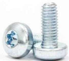
Резьбовыдавливающие винты M5x12 DIN 7500C TX самостоятельно выдавливают резьбу непосредственно в момент своего монтажа. Процесс происходит за счет специальной входной части стержня, при этом металлические стружки не остаются. Винты имеют полукруглую цилиндрическую головку и шлиц TORX. "
