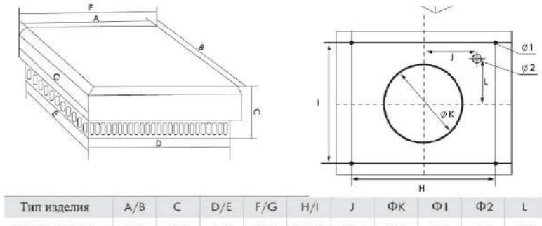
Вентилятор серии F2E предназначен для установки на потолочную панель корпуса.
