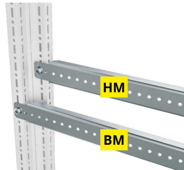
Предназначена для монтажа облегченного навесного оборудования при помощи резьбовых винтов с шагом 12,5 мм. Рейка крепится на наружный монтажный уровень рамы RS52. Статическая нагрузочная способность одной рейки до 50 кг.
