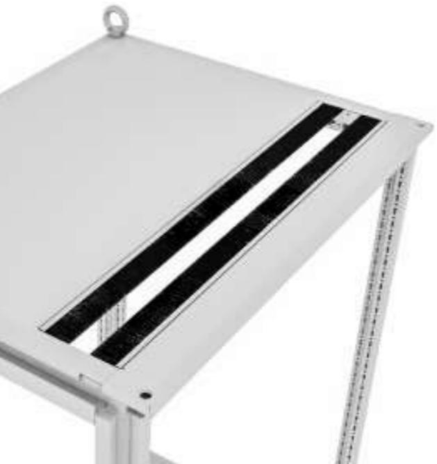
Панель потолочная с щеточным вводом двухсекционная RS52 предназначена для замены серийной потолочной панели. Симметричная конструкция рамы RS52 позволяет установить потолочную панель, тем самым обеспечивая ввод кабеля сбоку. Двухсекционное исполнение позволяет добавлять кабели после установки потолочной панели.
