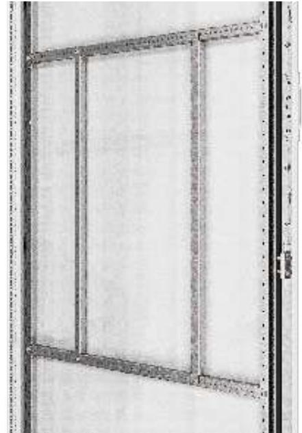
Рейка глухой двери предназначена для монтажа оборудования на внешние глухие двери шкафов RS52 в качестве горизонтальных или вертикальных направляющих для обеспечения крепления к ним проводников и иного шкафного оборудования. Статическая нагрузочная способность одной рейки до 50 кг.
