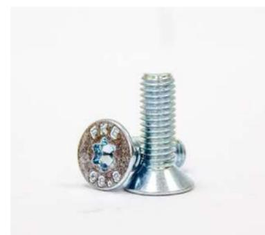
Винт M5x16-8,8 ISO 10642 со шлицем Torx имеет потайную голову. Расчитан на условия высоких нагрузок. Крепежный элемент является высокопрочным, изготавливается с полной резьбой или с неполной.
