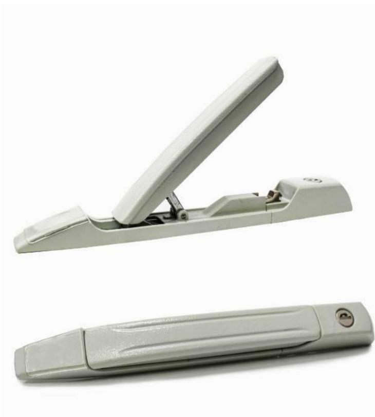
Замок-ручка комфортная применяется как альтернатива замку-накладке для более удобного открывания и запираения дверей шкафов RS52. Устанавливается в стандартные монтажные отверстия, с использованием существующих запирающих тяг. В комплекте поставляется ключ для блокировки механизма.\*
