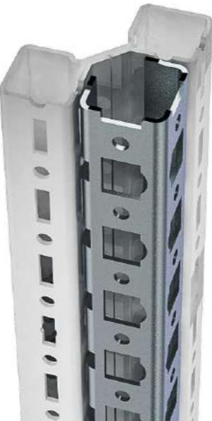
Шина адаптерная служит для выравнивания/совмещения монтажных уровней. Крепится на вертикальных профилях шкафов RS52 (по всей высоте или частично).
