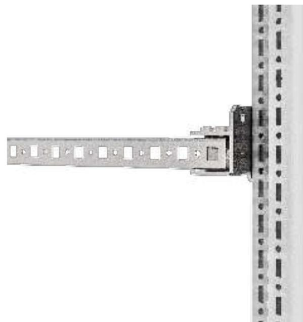
Планка монтажная 23x23 предназначена для монтажа навесного оборудования при помощи резьбовых выдавливающих винтов с шагом 25,0 мм, клетьевых гаек и винтов с шагом 25,0 мм. Крепится при помощи специальных комплектов крепления планок. Дополнительно необходимо приобрести комплект крепления планок RS52 23x23.
