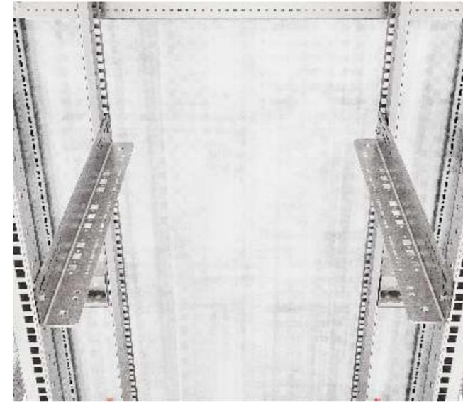
Монтажные шины 42x57 предназначены для монтажа 19-дюймового оборудования между передней и задней монтажными плоскостями в качестве опоры для тяжелого оборудования. Боковая системная перфорация обеспечивает боковую вентиляцию компонентов. Эффективная опорная поверхность - 51 мм.
