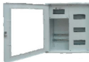
ЩУНСЗ-4х6-СИЗ-УХЛ4 * Навесной, с дверкой со стеклом, под индукционный счётчик до 24 модулей
