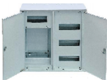
ЩУНЗ-4х9-СИЗ-УХЛ4 Навесной, с цельнометаллическими дверками, под индукционный счётчик до 36 модулей
