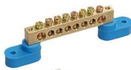
Применяются в производстве электрощитового оборудования. Боковые отверстия для ввода проводников диаметром 5 мм. Винты для крепления – М4. Сечение шины 9 мм х 6 мм. Шаг между отверстиями 7 мм. Номинальный ток, на который рассчитаны шины – 100 А.
