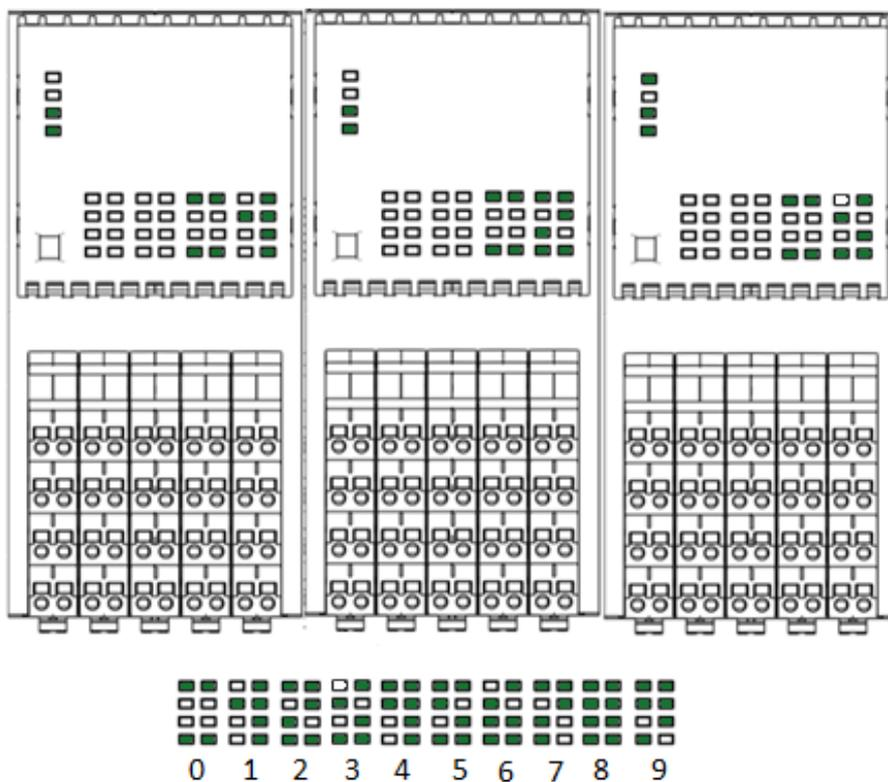
Рисунок 13 – Отображение адреса модуля ввода/вывода на панели группы функциональных индикаторов
