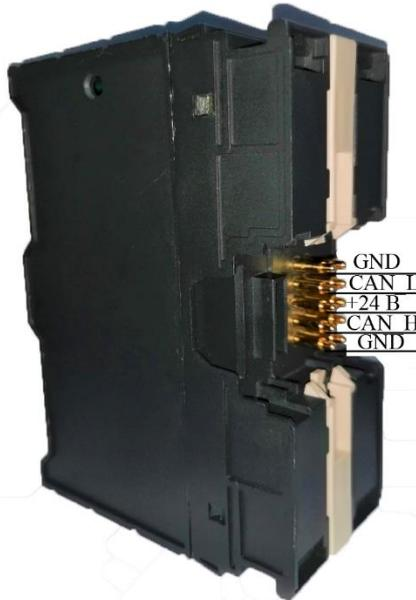
Рисунок 10 – Назначение внешних подпружиненных контактов на задней части корпуса процессорного модуля
