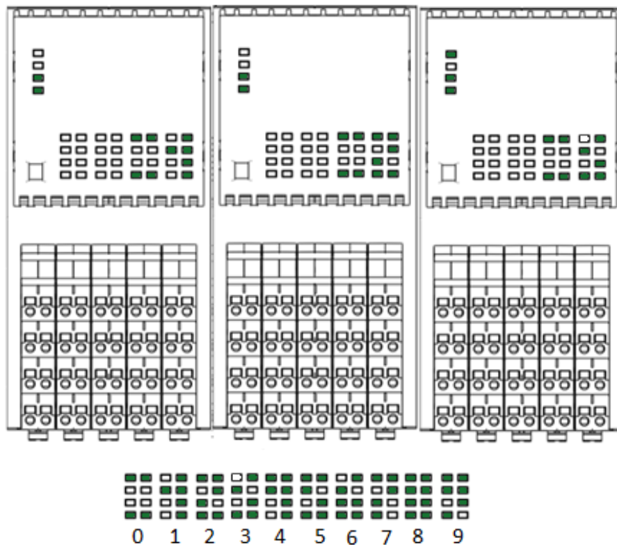
Рисунок 13 – Отображение адреса модуля ввода/вывода на панели группы функциональных индикаторов
