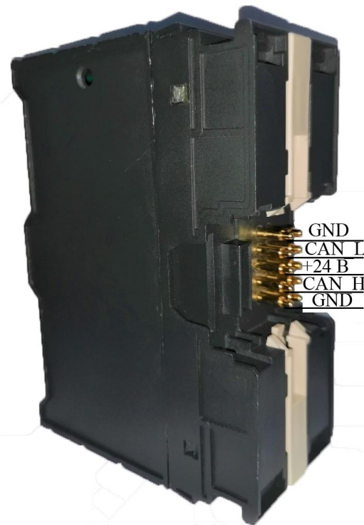
Рисунок 10 – Распиновка внешних подпружиненных контактов на задней части корпуса процессорного модуля
