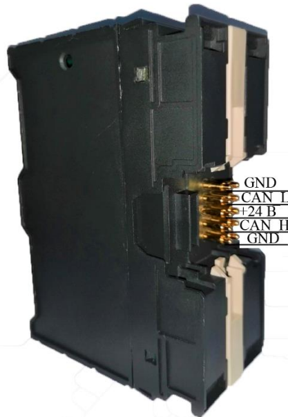
Рисунок 13 – Назначение внешних подпружиненных контактов на задней части корпуса процессорного модуля
