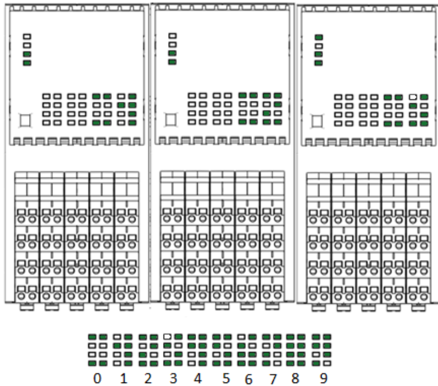
Рисунок 17 – Отображение адреса модуля ввода/вывода на панели группы функциональных индикаторов
