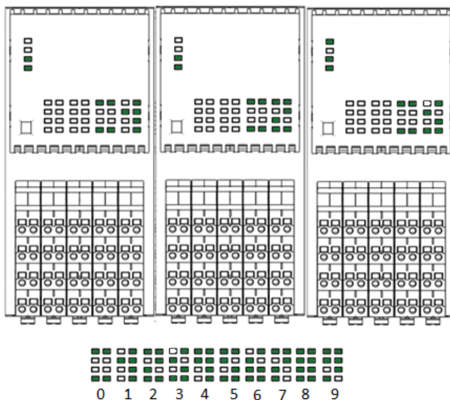
Рисунок 18 – Отображение адреса модуля ввода/вывода на панели группы функциональных индикаторов
