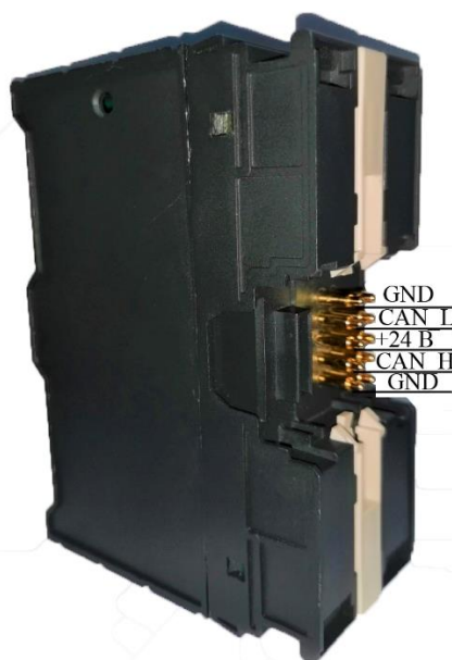
Рисунок 42 – Назначение внешних подпружиненных контактов на задней части корпуса адаптера сетевого УВВ Profinet
