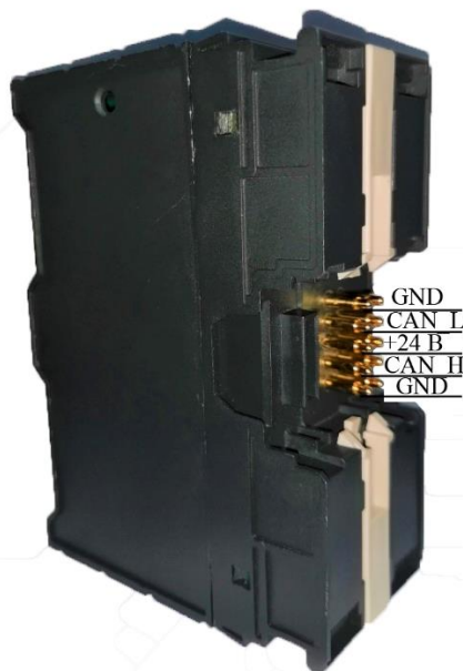
Рисунок 14 – Назначение внешних подпружиненных контактов на задней части корпуса процессорного модуля
