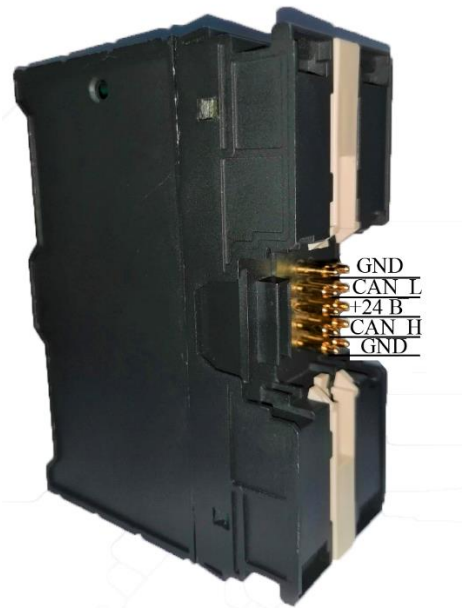
Рисунок 14 – Назначение внешних подпружиненных контактов на задней части корпуса процессорного модуля
