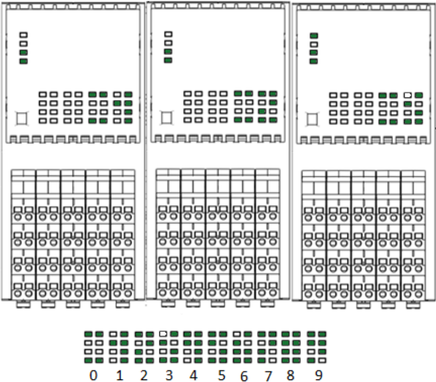
Рисунок 18 – Отображение адреса модуля ввода/вывода на панели группы функциональных индикаторов
