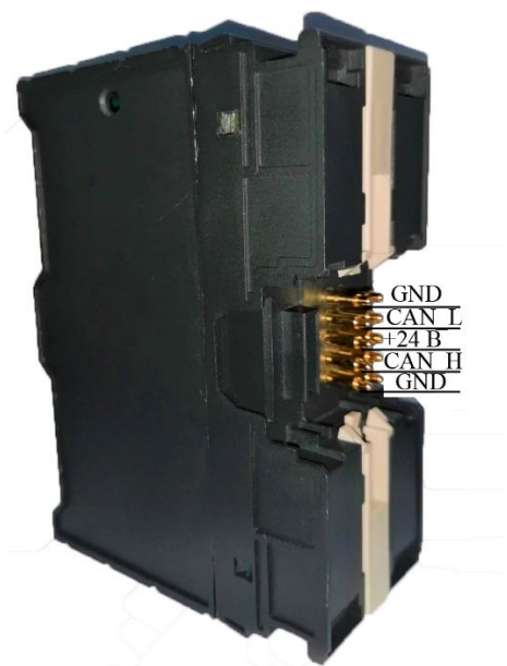
Рисунок 43 – Назначение внешних подпружиненных контактов на задней части корпуса адаптера сетевого UBB Profinet
