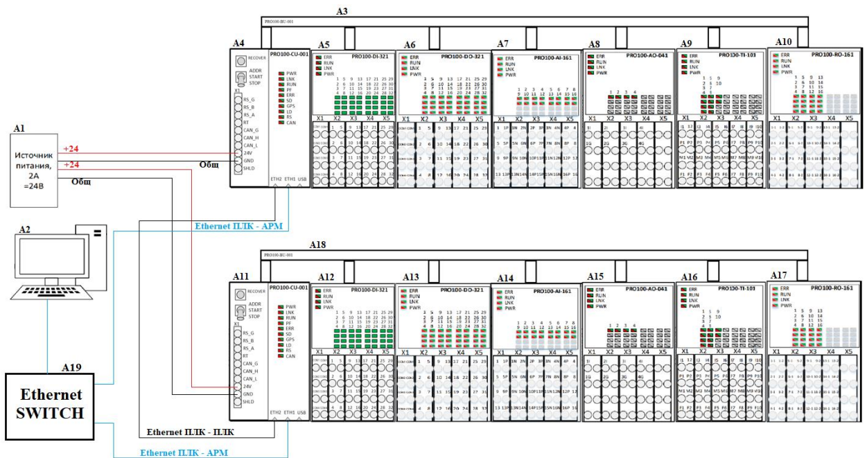
Рисунок 35 – Схема полного резервирования
