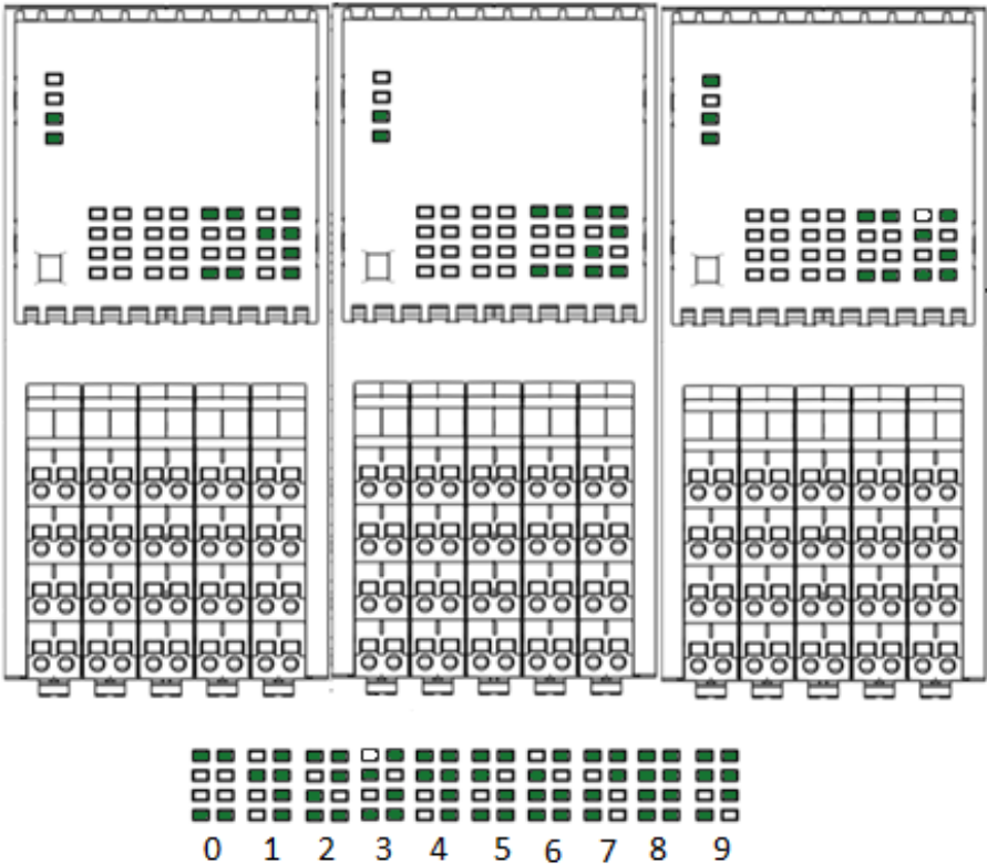
Рисунок 15 – Отображение адреса модуля ввода/вывода на панели группы функциональных индикаторов
