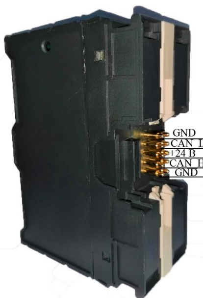
Рисунок 12 – Назначение внешних подпружиненных контактов на задней части корпуса процессорного модуля
